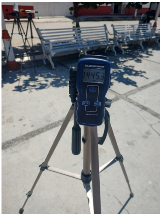
Figura 12. Registro de radiación solar en espacios exteriores de convivencia de comunidades indígenas. Fuente: Autores, 2024.
